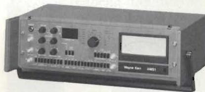
Sistema di misura multifunzione che provvede alla misura di molti parametri nel campo audio.
