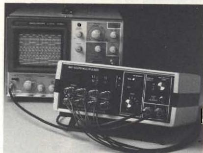
"Scope multiplexer" uno strumento da laboratorio di basso costo.
